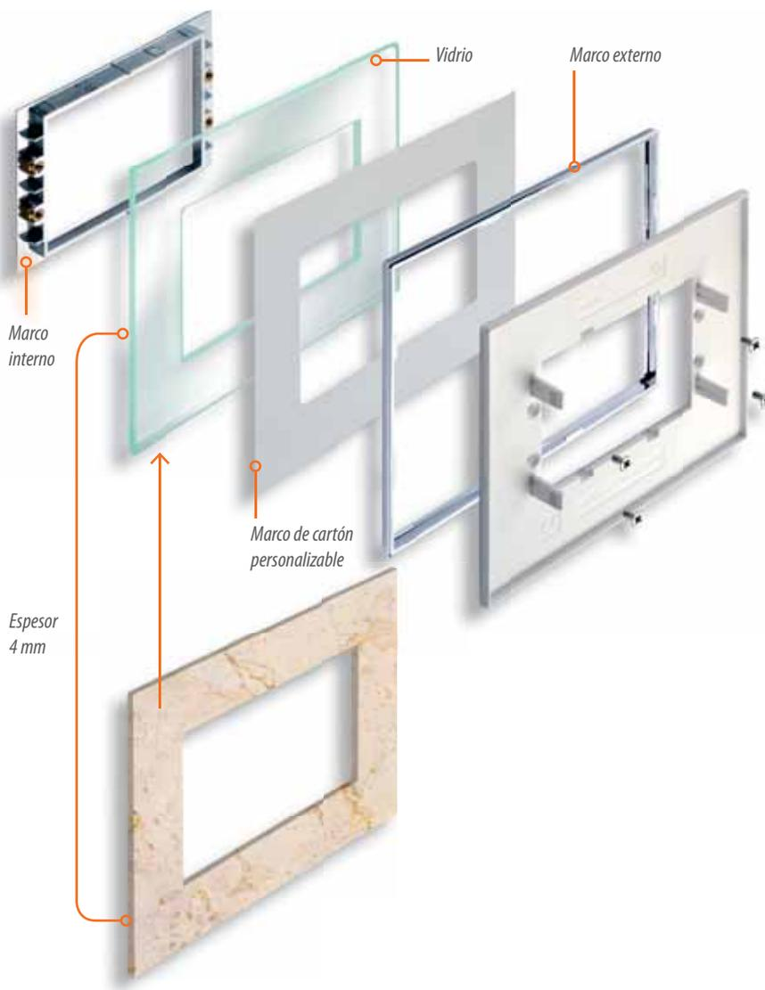
➤ Kristall se puede desmontar fácilmente extrayendo los 4 tornillos dispuestos bajo el marco cromado. Láminas metálicas (cobre, oro y plata), tejidos, bordados y tapizados, pueden ser fácilmente insertados bajo el vidrio obteniendo un efecto único.
