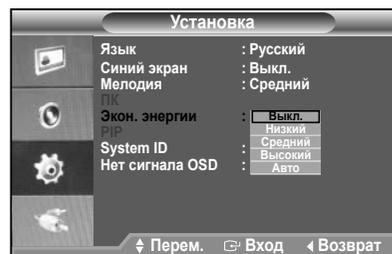
С помощью этой функции настраивается яркость монитора для снижения потребления энергии. При использовании монитора в ночное время установите для режима Energy Saving (Экономия энергии) значение High (Высокий), чтобы снизить негативное воздействие на глаза, а также уменьшить потребление энергии.
