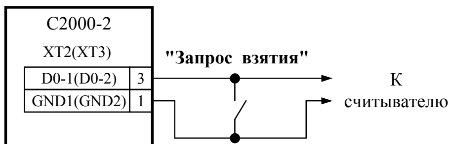
Рисунок 5 Подключение кнопки "Запрос взятия"
